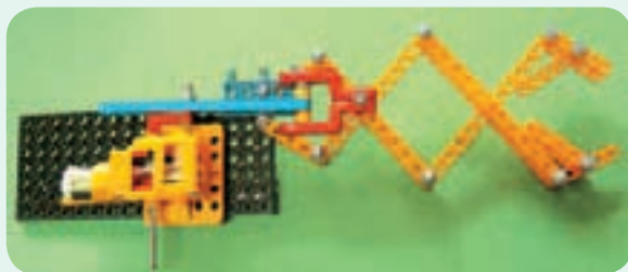
图2-28 安装电动机齿轮箱和曲柄滑块机构
