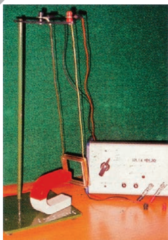
图6.1.4 通电导体在磁场中受到安培力作用
