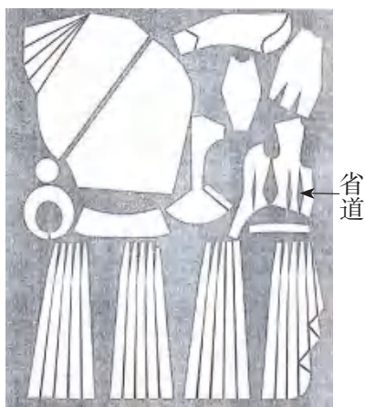
图1-13 具有省道的服装结构图
