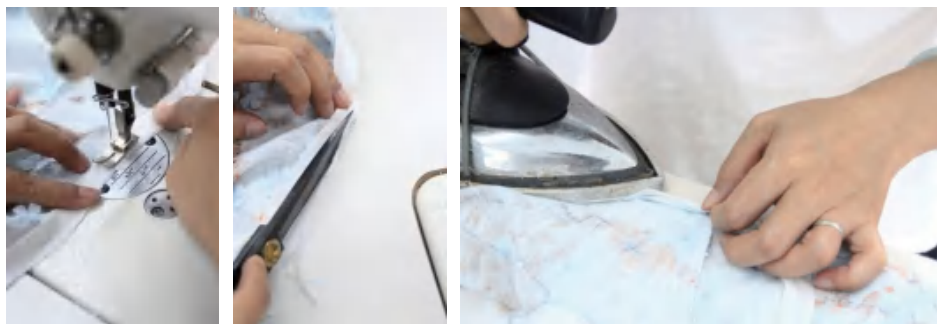
图3-40 缝制袖窿弧线
