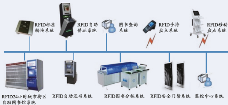
图2.4.5 使用RFID技术的图书馆系统
