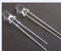
图2.6.3 红外线发射管
