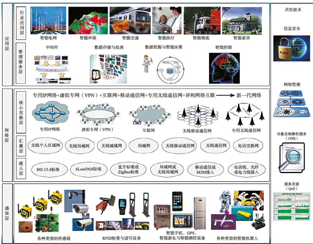
图2.4.6 物联网的体系结构模型
