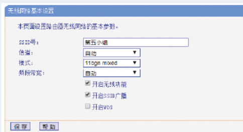
图2.3.10 配置“无线设置”的“基本设置”
