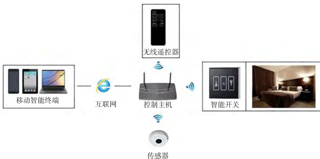
图4-2 智能照明系统组成示意图
