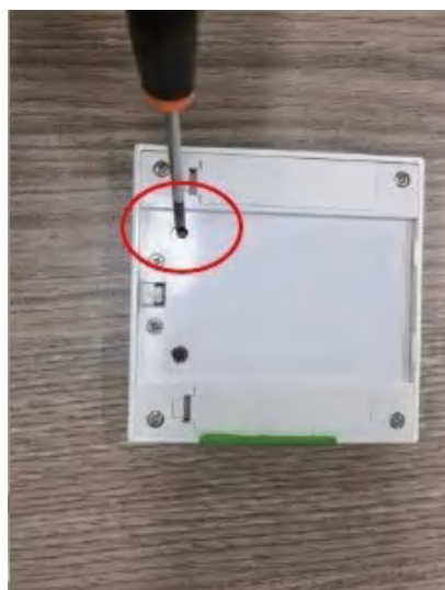
图4-12 窗帘遥控器背面的对码按钮
