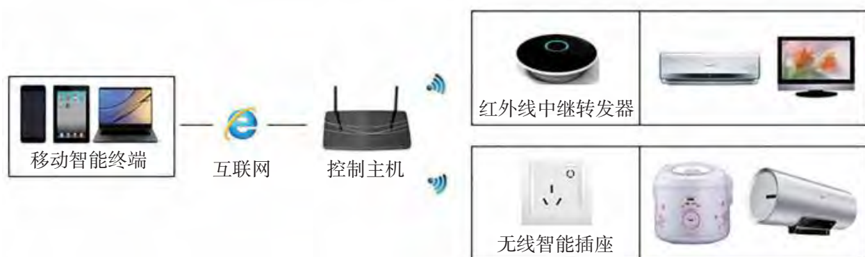
图4-3 智能家电系统组成示意图
