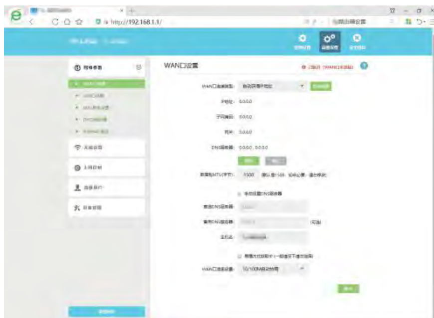
图3-38 WLAN口上网设置页面
