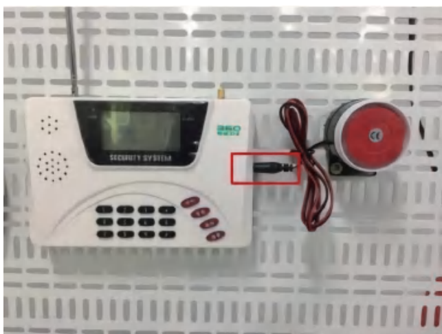
图4-23 安装红外报警主机和报警扬声器
