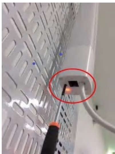
图4-11 窗帘电机下方的对码孔
