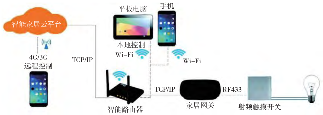
图3-30 智能照明系统方案2项目蓝图
