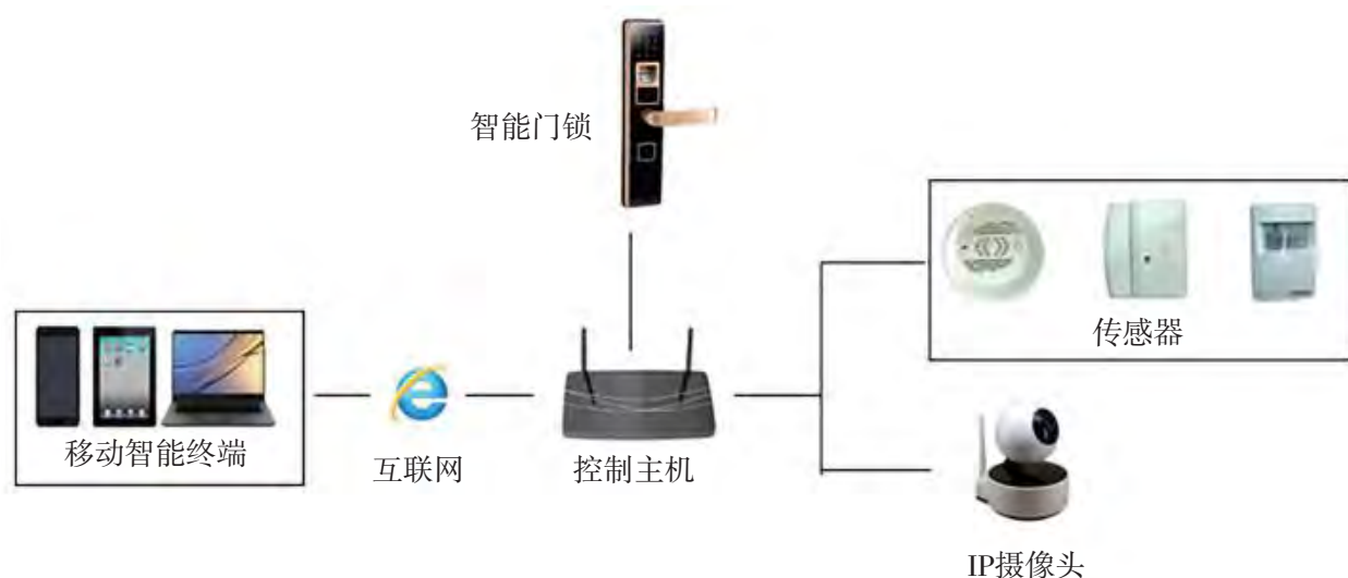
图4-4 智能安防报警系统组成示意图
