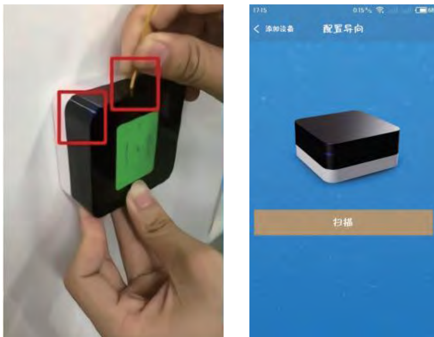
图4-17 在App上添加红外线中继转发器
