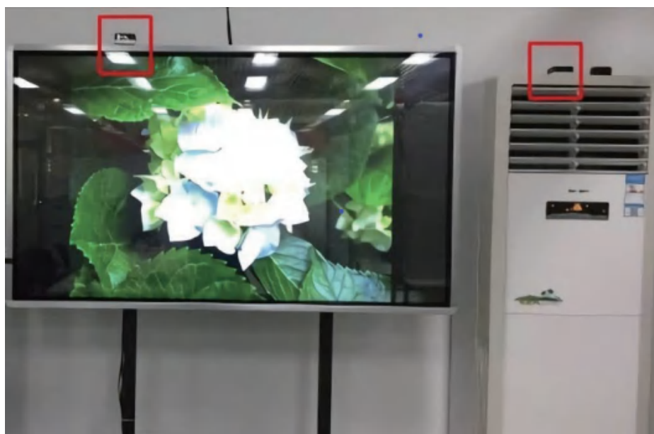
图4-18 红外线中继转发器安装位置
