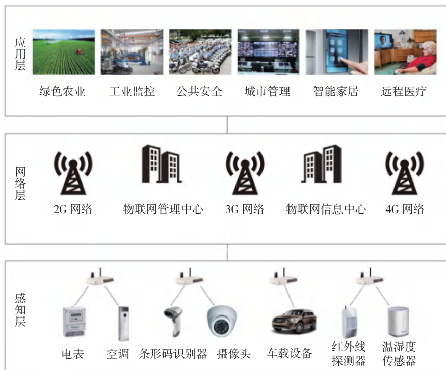
图2-3 物联网体系结构示意图
