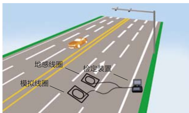
图1.3.1 地感线圈采集交通数据
