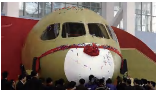
图1-9 三维打印制造的大型客机主风挡窗框
