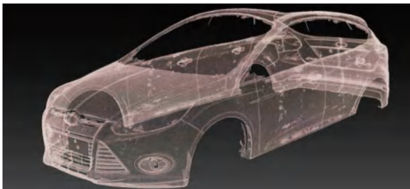
图4-58 利用逆向工程技术设计汽车外形
