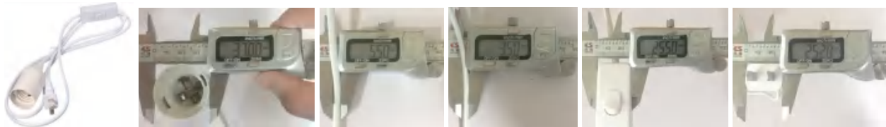
图4-21 测量灯头配件各部分的尺寸
