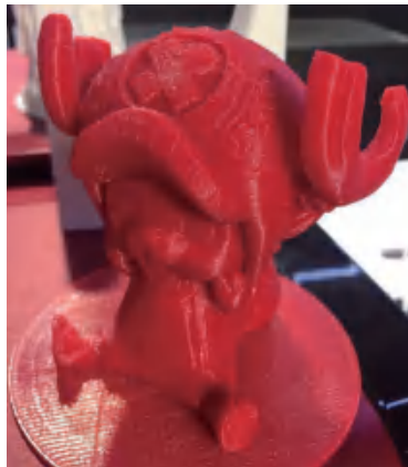
图2-6 熔融沉积成型打印的产品
