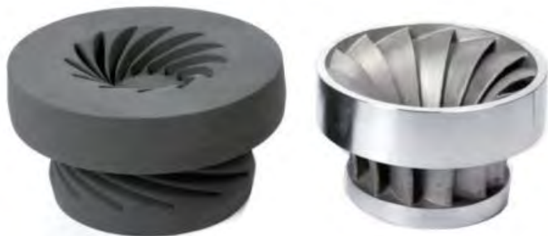
图4-47 三维打印的砂模和砂型铸造的金属零件
