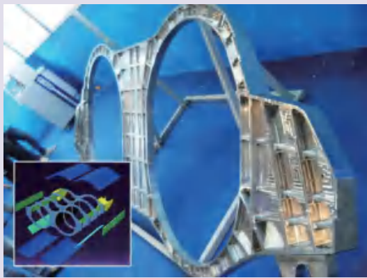
图4-49 激光快速成型制造的TA15钛合金结构件
