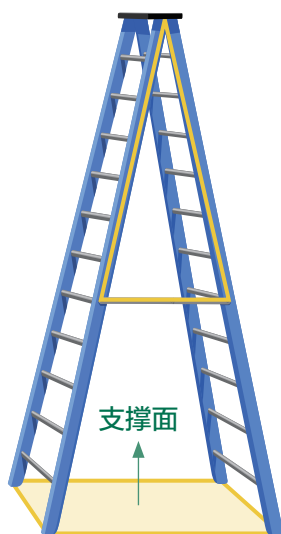
图1-26 人字梯形状与支撑面示意图
