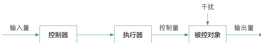
图4-17 开环控制系统的干扰情况
