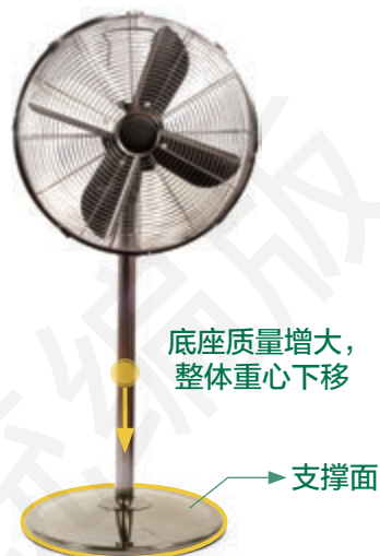
图1-23 落地电风扇重心与支撑面示意图
