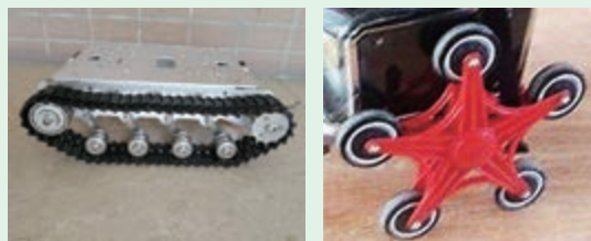
履带式爬楼梯方案 组合轮式爬楼梯方案
