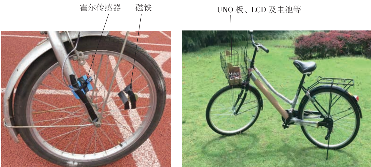
图 2-43 在自行车上安装自行车里程仪
