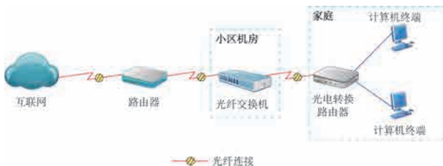
图 2.29 家庭光纤入户的接入方式示意图
