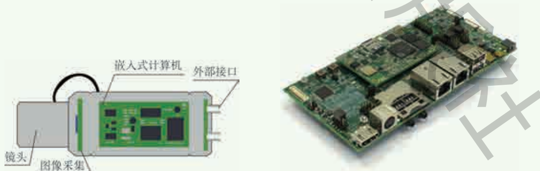
图 2.3 车牌号码拍摄识别设备(左)与某嵌入式计算机(右)示意图
