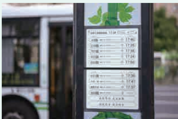
图 1.7 公交站点电子显示屏
