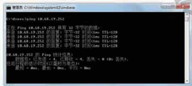
图 2.32 使用 ping 命令测试网络连通情况
