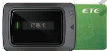
图 1.17 车载 ETC 装置
