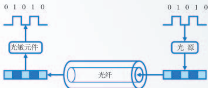
图1.2.6 光纤通信原理示意图
