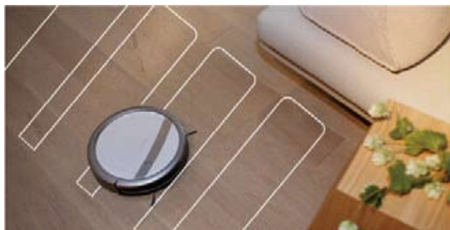
图2.4.20 扫地机器人的路径规划
