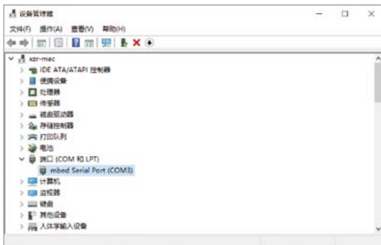
图2.4.8 通过“设备管理器”查看COM端口号
