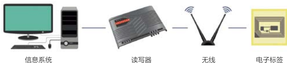
图2.4.12 信息系统利用RFID技术识别外部世界的事物
