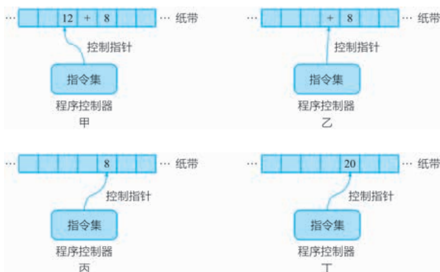
图1.1.1 图灵机模型计算“12+8”的过程示意图
