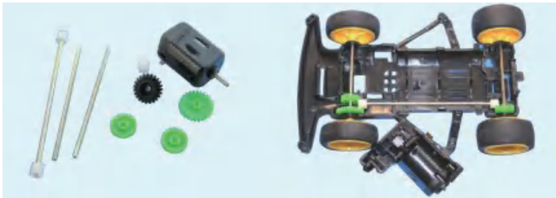
图2-16 四驱车模型的齿轮传动装置
