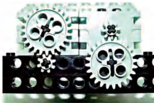
图2-9 机器人中的齿轮传动
