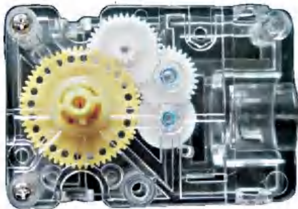
图2-14 齿轮系在机器人中的应用
