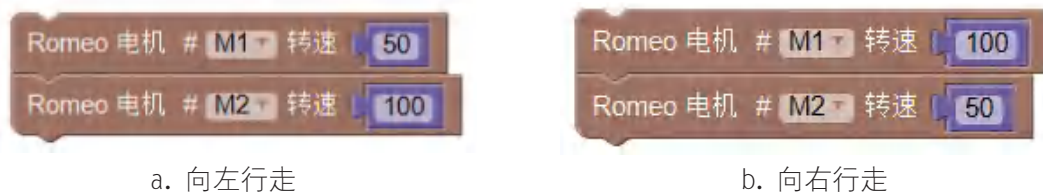
图5-6 机器人左、右行走方向的控制参数
