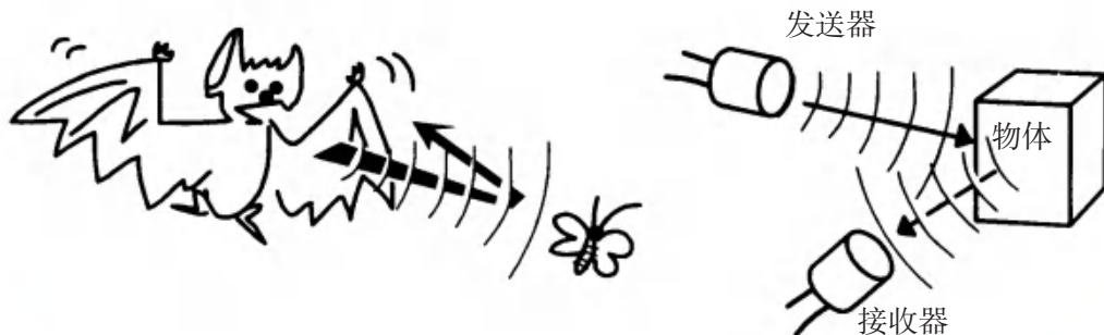
图4-12 超声波传感器原理
