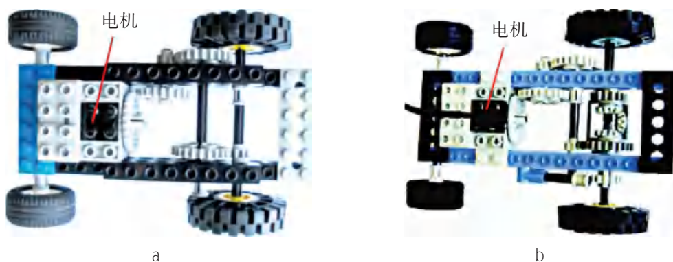
图2-31 齿轮传动的四轮形式
