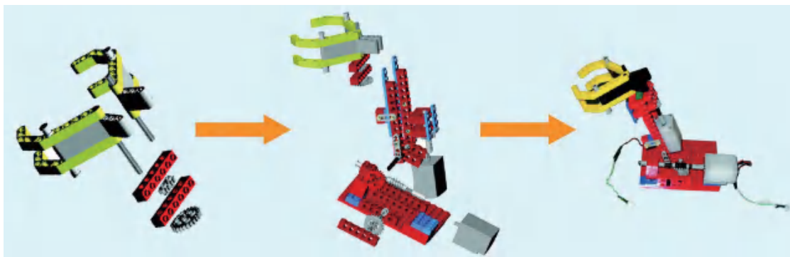
图2-43 机器人手爪的拼装过程
