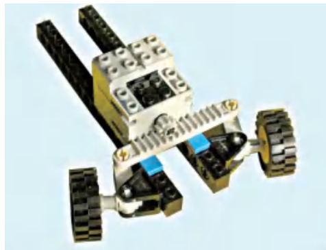
图2-11 机器人中的齿条与齿轮
