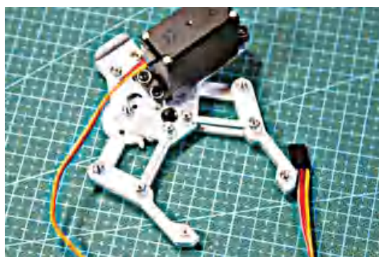
图2-53 安装手爪控制舵机
