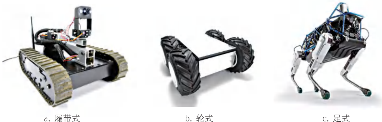
图2-30 机器人移动机构的主要方式
