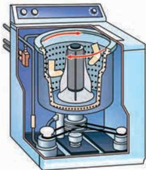
图 3-1 模拟手工洗衣流程的全自动洗衣机
