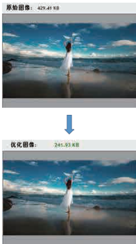
图 1.24 图像文件的有损压缩示例
