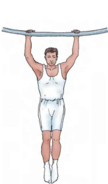
图1-14 单杠横杆承受弯曲变形的力
