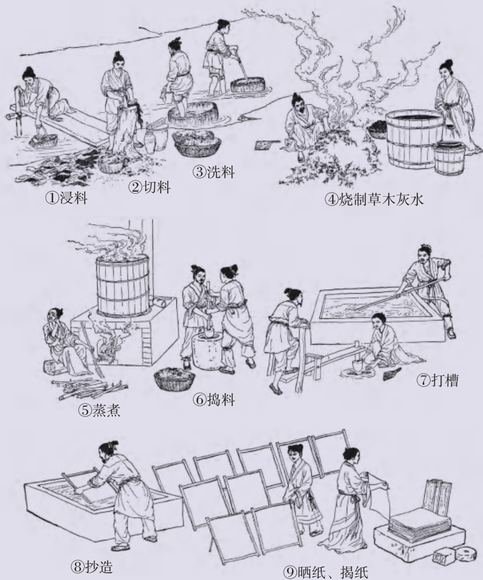
图2-5 汉代造麻纸工艺流程
