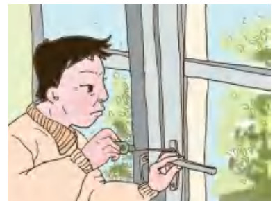
图1-16 螺丝刀受扭曲变形的力
