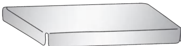
图1-51 薄钢板折叠构成的板架
