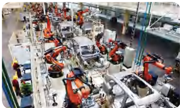
图3-3 汽车焊接自动化机器人流水线
