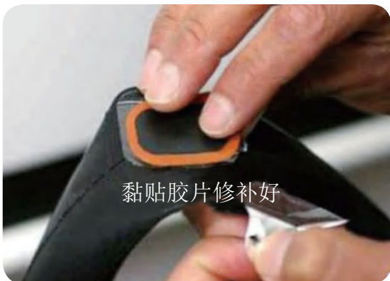
图4-50 修补破损部位
