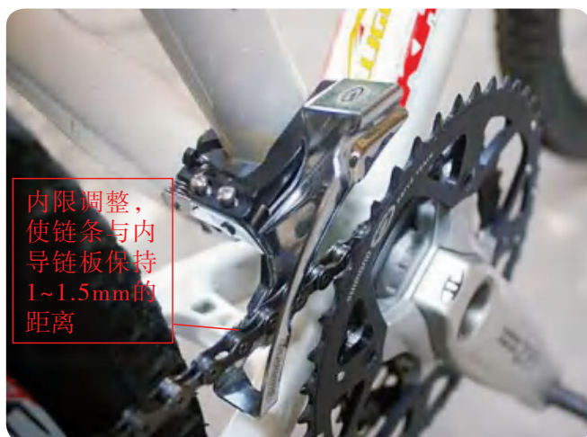
图4-36 调整变速器前限位螺钉
