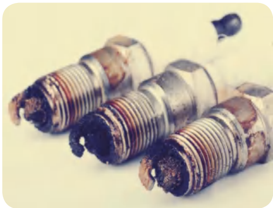
图4-32 严重腐蚀的火花塞
