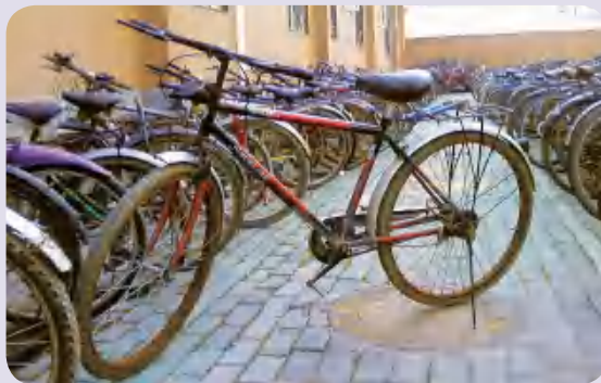
图4-13 缺乏保养的自行车出现锈迹和破损
