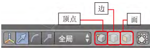
图3-20 3D视图标题栏以及顶点、边与面图标
