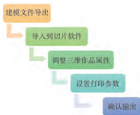
图6-7 三维作品的三维打印发布流程示意图
