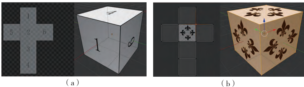
图4-15 全部落在UV网格中的效果以及只有一面落在UV网格中的效果
