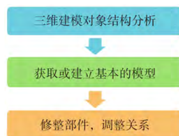
图3-4 三维模型设计流程
