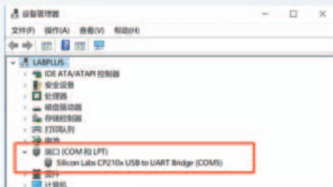
图1.1.9 在计算机设备管理器中查看端口号
