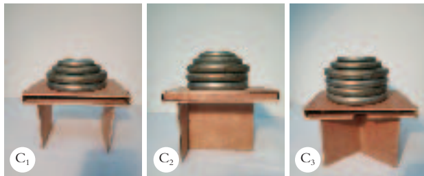
图2-23 测试三种便携式小凳的相关性能
