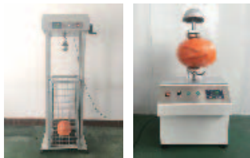
图2-28 安全帽的强化试验
