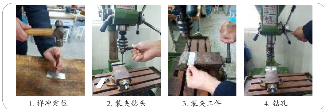
图6-45 钻孔的操作步骤
