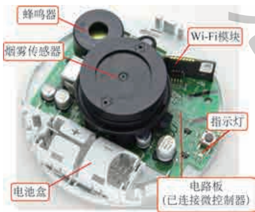
图 1.6 烟雾报警器内部器件
