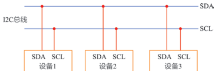
图3.2.24 I2C总线示意图
