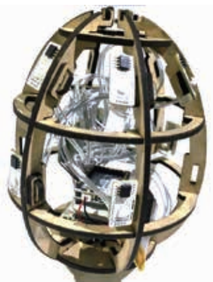
图2.1.2 蛋内采集端的电子电路和结构支架
