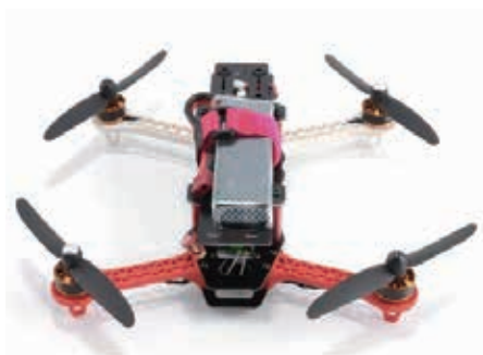
图1.3.2 基于OpenPilot开发的竞技无人机
