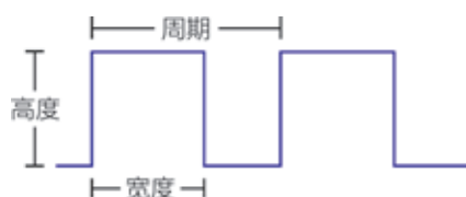
图3.2.17 PWM脉冲宽度调制示意图
