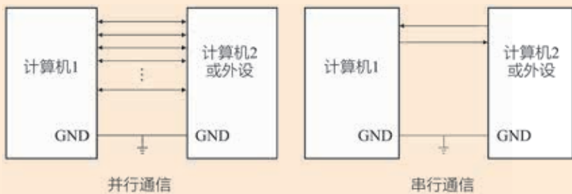
图3.2.27 并行与串行通信示意图
