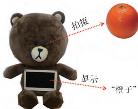
图4-3 拍照识物智能玩具设计示意图
