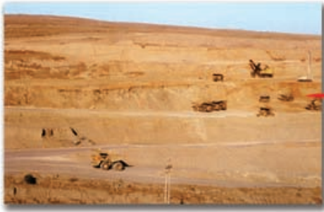
①平朔露天煤矿进行岩土剥离， 为煤炭开采做准备
