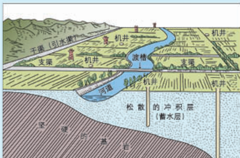
华北平原渠灌、井灌结合示意图
