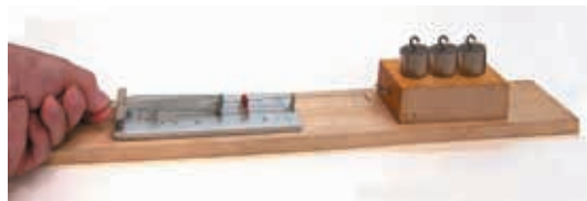
图 3-3-1 探究滑动摩擦力大小的实验
