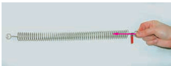
图 3-2-2 弹簧的形变与弹力
