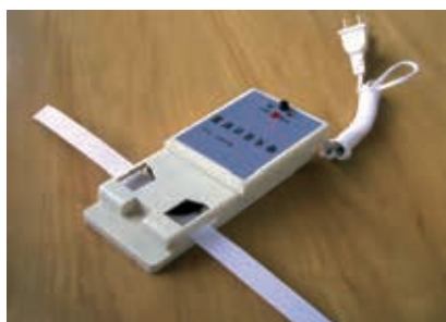
图 1-3-4 电火花打点计时器
