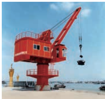
图 3-1-4 起重机 - 所吊货物的重心随所吊货物的位置而变化
