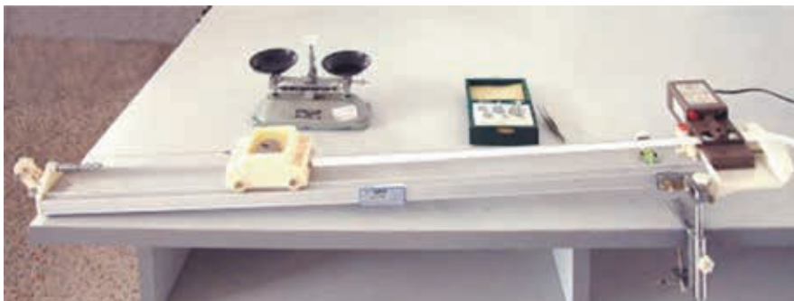
图 1-4-5 研究匀变速直线运动的实验装置
