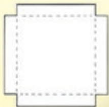
柱底、柱顶的折叠示意图
