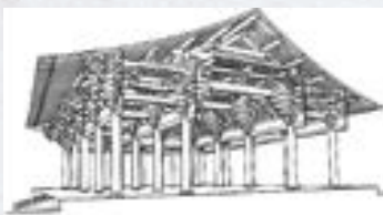
佛光寺东大殿梁架结构示意图
