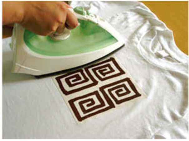
4. 热处理：印刷后进行熨烫，以避免水洗时掉色。
