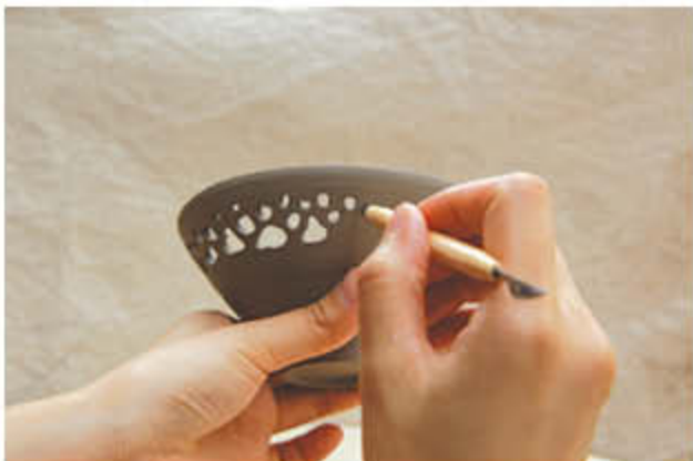
2. 在坯胎半干时用工具雕刻，注意先刻画边框，雕刻时不要一次就刻穿，要慢慢地一层层地雕，以免雕破胎体。
