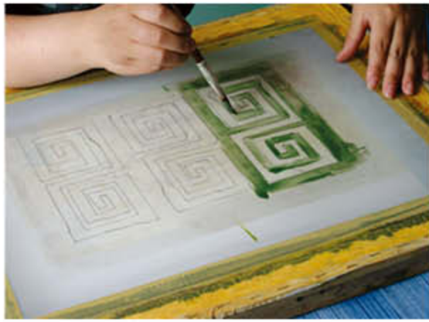
2. 填堵网孔：使用相应的堵孔材料描画堵孔制版。
