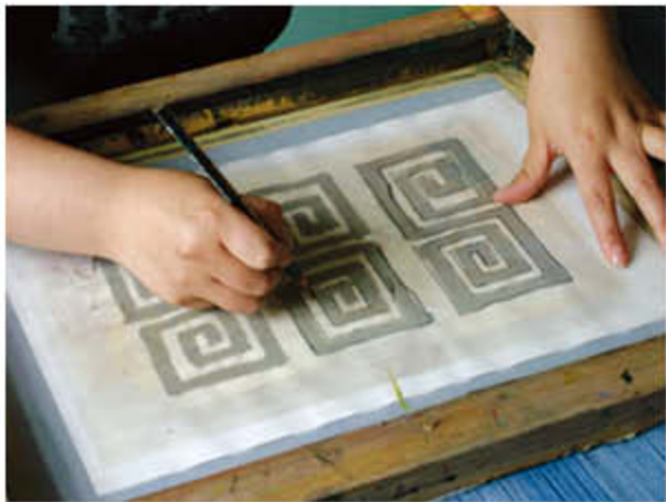
1. 版上描稿：用铅笔把要印的造型在空白丝网版上描画下来。
