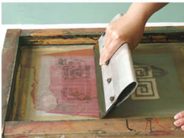
3. 印刷：刮板与丝网版呈 70^\circ 夹角，在版面上平行刮动，注意用力要均匀。
