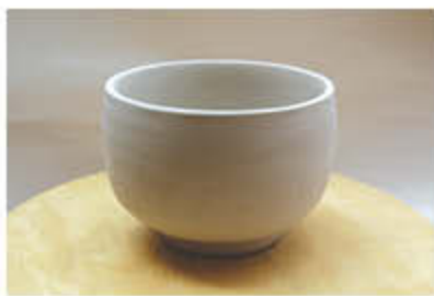
刚完成的坯体
