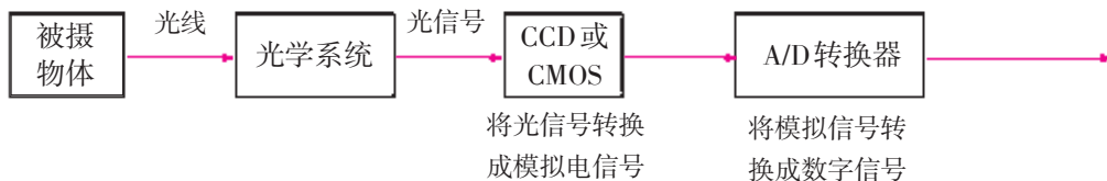
图 5-4-4 数码摄像机工作原理框图
