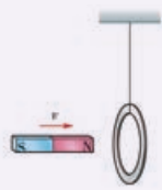
图 2-2-1 探究感应电流方向的实验
