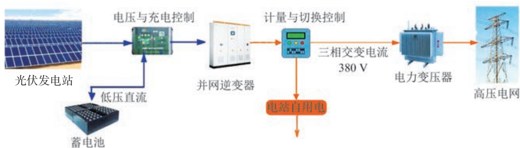
图 3-1-12 光伏发电站的发电、送电运行图
