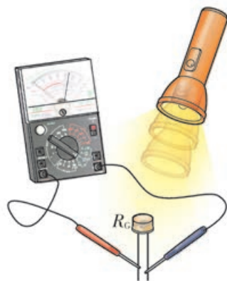
图 5-1-5 光敏电阻导电性实验装置图
