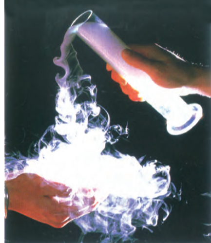
(c) 常温下，干冰变成二氧化碳气体(并使周围水蒸气凝结)
