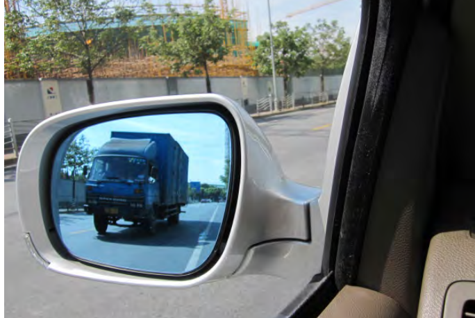
图3-32 汽车的后视镜是凸面镜
