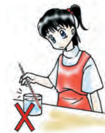
(c) 温度计下端不能与杯底、杯壁接触
