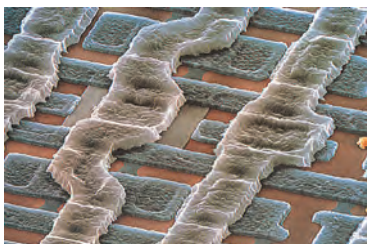
(b) 电子显微镜下观察到的计算机微处理器电路
