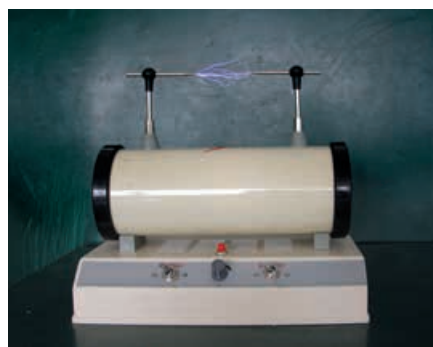
图 1-3-3 感应圈火花放电现象
