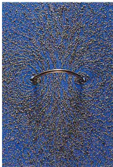
图 5-2-10 铁屑在环形电流磁场中的分布
