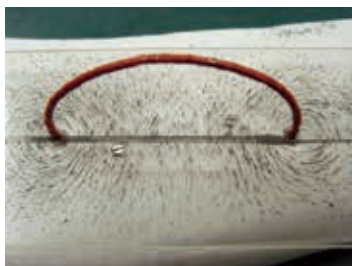
图3-1-8 铁屑显示的环形电流磁场的情形
