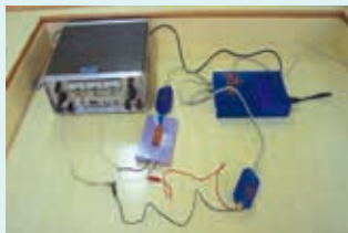
图3-2-10 用传感器测磁感应强度
