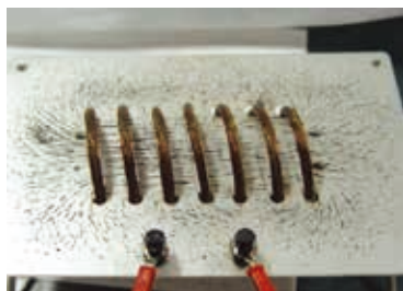
图3-1-9 铁屑显示的通电螺线管磁场的情形
