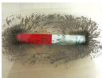
(a) 铁屑在条形磁铁周围的排列情形
