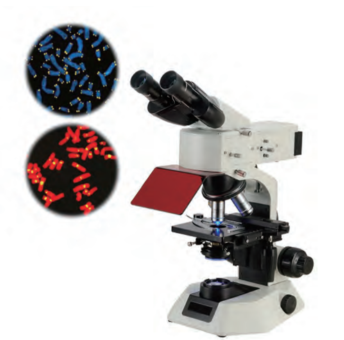
图 2-14 荧光显微镜及镜下看到的染色体探针杂交结果（放大倍数：1000×）
