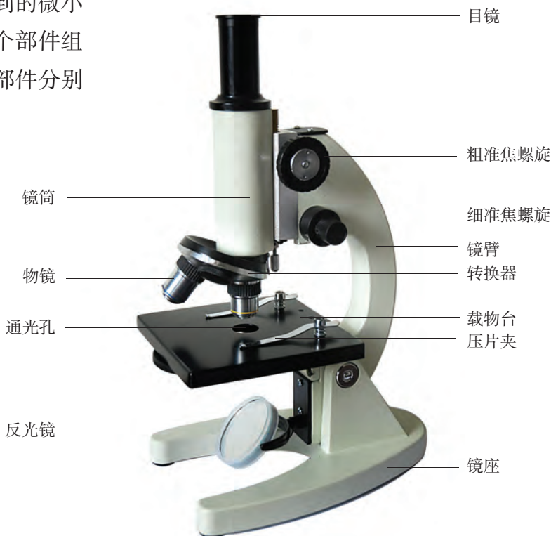
图 1-1 显微镜的结构
