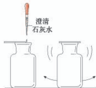
图1-18 用澄清石灰水检验
