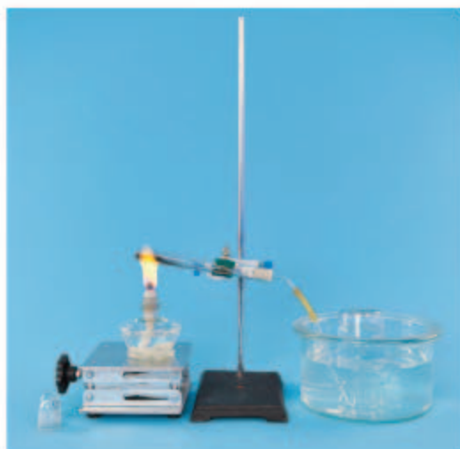
图2-14 加热高锰酸钾制取氧气
