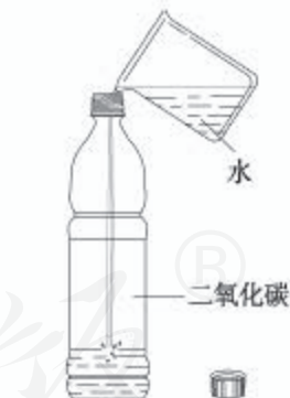
图6-15 二氧化碳的溶解性实验
