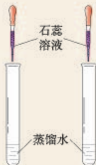
(I) 向蒸馏水中滴入石蕊溶液 图6-25 二氧化碳与水的反应
