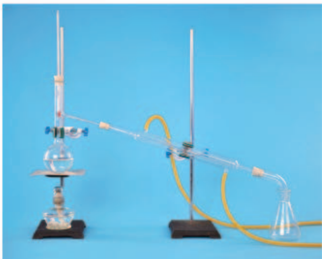
图4-20 实验室常用的蒸馏装置
