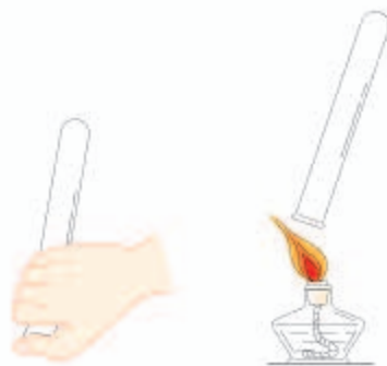
I. 用拇指堵住集满氢气的试管口 II. 靠近火焰，移开拇指点火
