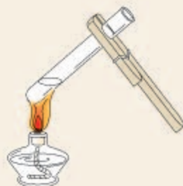
(III) 将通入二氧化碳的试管加热
