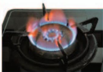
图7-31 燃气燃烧出现黄色火焰
