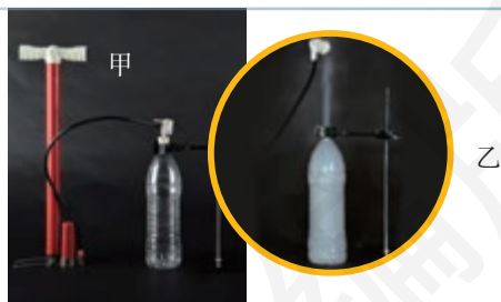
图 3.1-4 观察橡胶塞跳出时瓶内的变化
