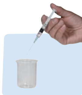
图 1.2-2 记录油酸酒精溶液的滴数
