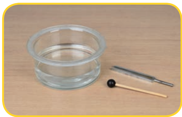
用音叉、音锤和水做发声实验。
