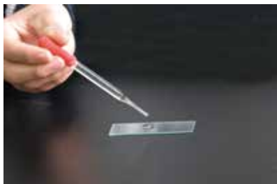
(2) 把载玻片放在实验台上，用滴管在载玻片中央滴一滴清水。
