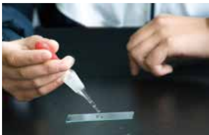
(2) 把载玻片放在实验台上，用滴管在载玻片中央滴一滴生理盐水。
