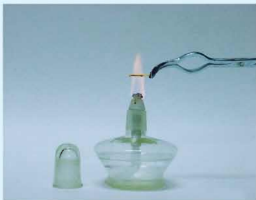
图1-16 比较酒精灯内外焰温度的实验
