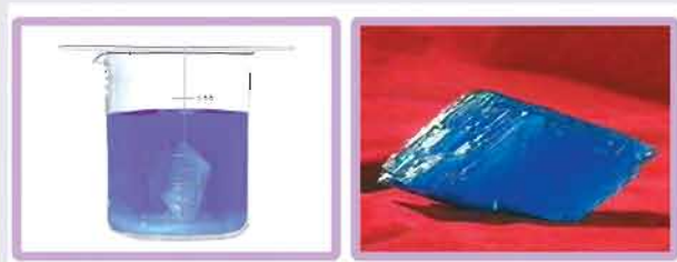
图6-10 硫酸铜晶体的制备
