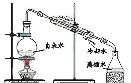
图2-21 实验室制取蒸馏水的装置
