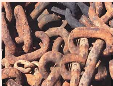
图2-10 铁的锈蚀是缓慢氧化过程
