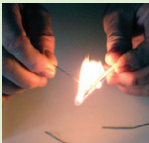
图 9-3-8 用火柴烧断熔丝
