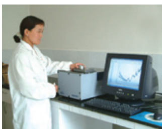
(b) 分析化学实验中，用色谱仪根据各种电磁波谱线的位置和强度，检测某种物质中含有哪些元素
