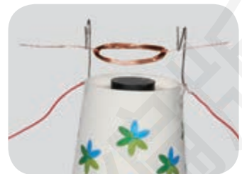
磁铁和线圈之间的距离近
