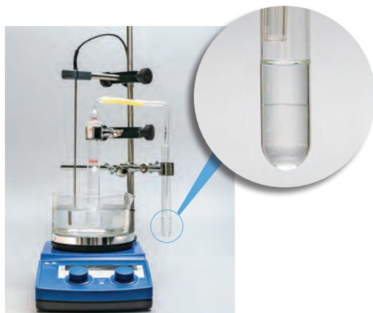
图 3.18 乙酸和乙醇的酯化反应
