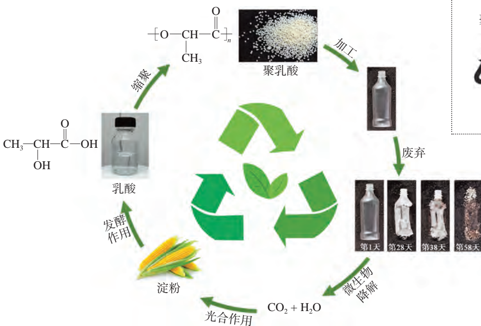
图 4.27 聚乳酸的生产及消耗循环
