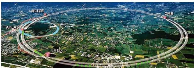
▲ 图5-5-4 这是LHC的鸟瞰示意图, 它的周长达27 km。ATLAS、CMS、ALICE和LHCb分别是不同的粒子探测器, 安装在四个地下巨洞中, 分布在LHC周围
