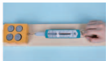
图 3.2-4 测量静摩擦力的实验装置
