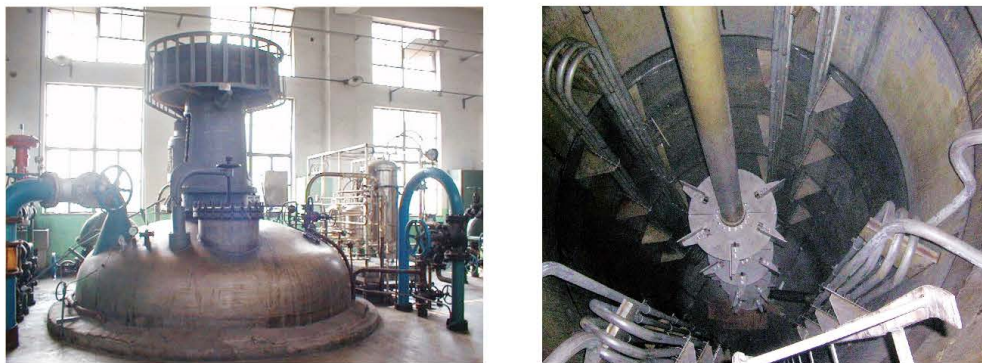
图 1-24 发酵罐（左）及其内部结构（右）
