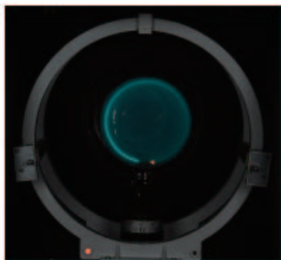
图1.3-4 施加垂直于纸面的磁场后，电子束沿圆轨道运动
