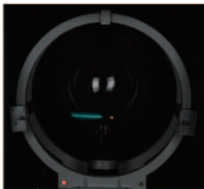
图1.3-3 没有磁场时电子束沿直线运动
