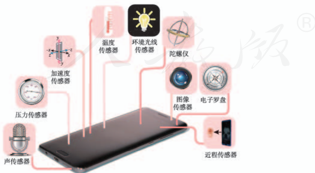
图5.1-6 智能手机中的部分传感器
