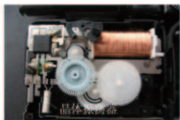
图4.1-4 石英电子钟里的晶体振荡器
