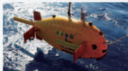
我国自主研发的探索号自治式水下机器人
