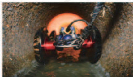
机器人在下水道里探测水下管网
