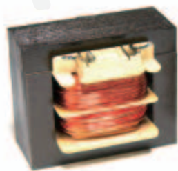
乙 小家电中的变压器
