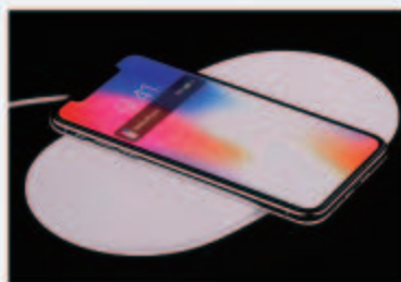
图3.3-4 对移动电话进行无线充电
