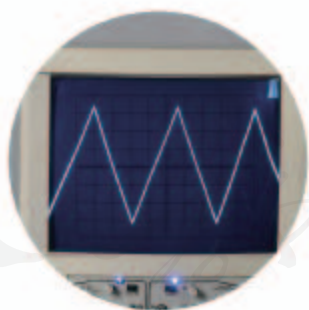
乙 示波器中的三角形扫描电压
