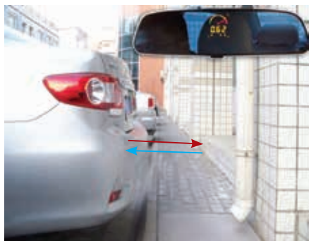
图 3-4-7 “倒车雷达”显示,车尾与管道之间的距离是 0.62 m
