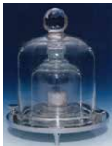
图6-1-4 在法国巴黎国际计量局保存着由铂铱合金制成的国际千克原器
