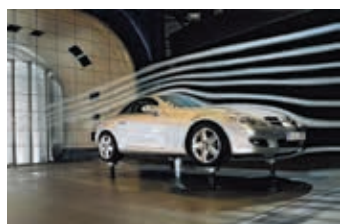
图 2-2-4 新型汽车的研制中,将汽车模型放在风洞中不动,让风高速迎面吹来,真实地模拟了汽车在空气中高速行驶的情形
