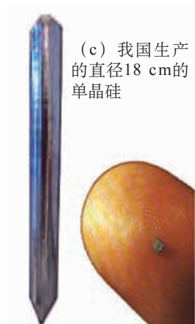
(d) 单晶硅是生产芯片的重要材料。在手指头上的芯片中，聚集了上百万个晶体管
