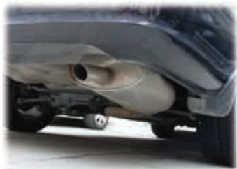
(a) 在汽车排气管上安装消声器
