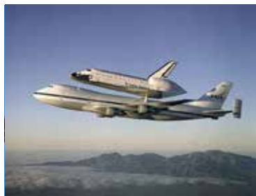
(a) 航天飞机用密度较小的新材料制造，可用飞机来运输
