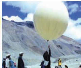
(c) 气象工作者利用密度很小的氢或氦气，制造探空气球，采集气象资料
