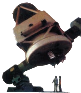
图 4-7-7 安装在北京天文台兴隆站 的反射望远镜口径 2.16m，夜晚能观 测到亮度相当于 20km 外的一根点着 的火柴发出的光那样的星星
